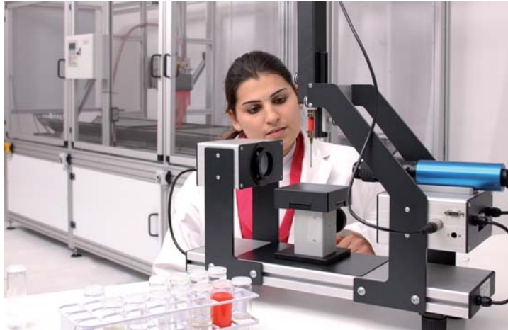
Messung der Oberflächenspannung und des Kontaktwinkels in den Labors der FMP TECHNOLOGY GMBH
