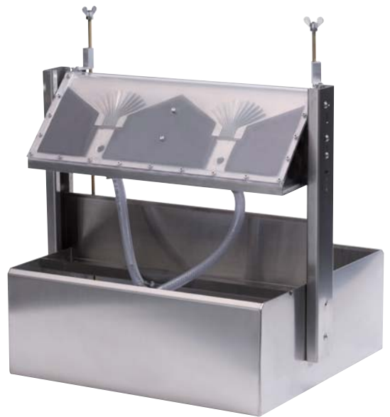
Gießrinne für Beschichtungen im „Curtain-Coating-Mode“
