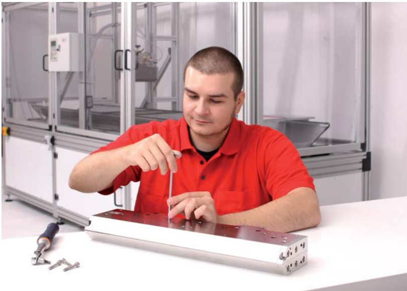
Montage einer 500 mm breiten FMP-Präzisionsdüse
