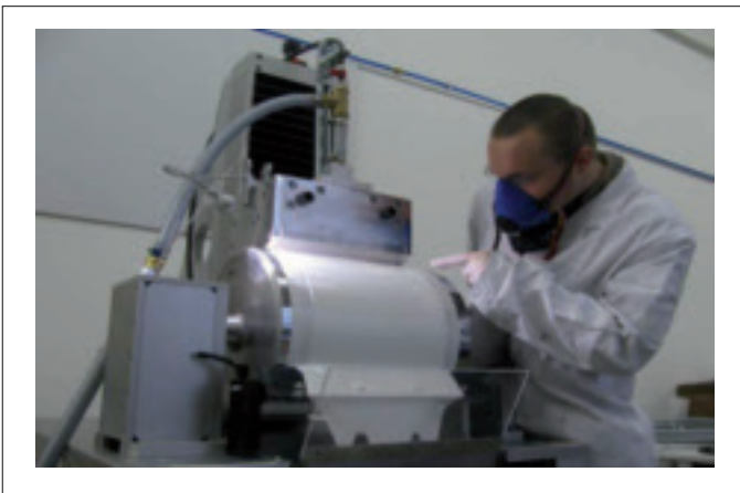
Abb. 7: 250 mm FMP-Düse am Rollenversuchsstand der Firma FMP Technology GmbH
